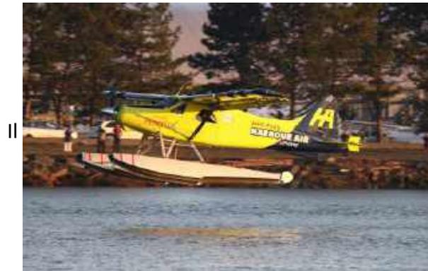
Le **10 Décembre 2019**, le **premier vol électrique commercial de l'histoire** à bord d'un **DHC-2 Beaver ePlane** de la compagnie Harbour Air décollant de l'aéroport de Vancouver au Canada. est équipé d'un **moteur électrique magni 500** de la compagnie **magniX** capable de développer **750 chevaux**, contre 450 chevaux avec le moteur ordinaire du Beaver (turbine PT6 de Pratt & Whitney).
