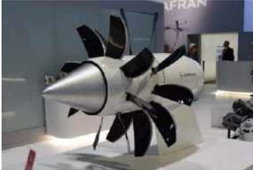
Les motoristes mènent des recherches sur des moteurs ouverts (Open rotor) afin d'augmenter le taux de dilution tout en limitant la traînée induite. Des tests sur banc d'essai au sol ont déjà été réalisés.
